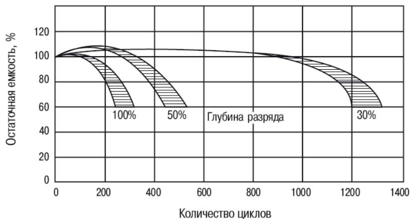
Рис. 7 Зависимость количества циклов от глубины разряда аккумуляторов Ventura
