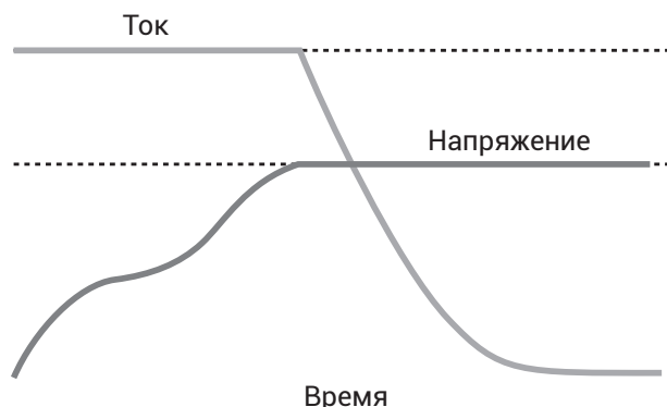
ЗАВИСИМОСТЬ ТОКА И НАПРЯЖЕНИЯ ОТ ВРЕМЕНИ ПРИ ЗАРЯДЕ ПО МЕТОДУ IU
