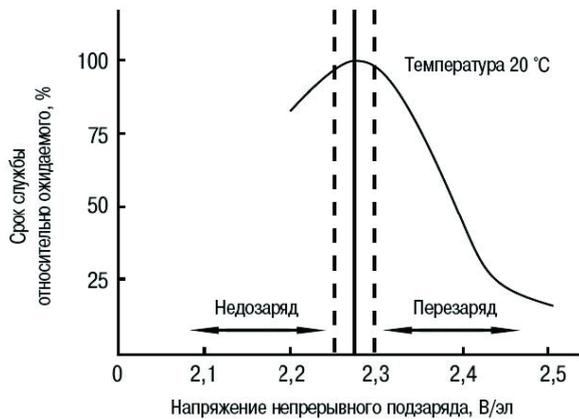
Рис. 8 Зависимость срока службы аккумулятора от напряжения подзаряда
