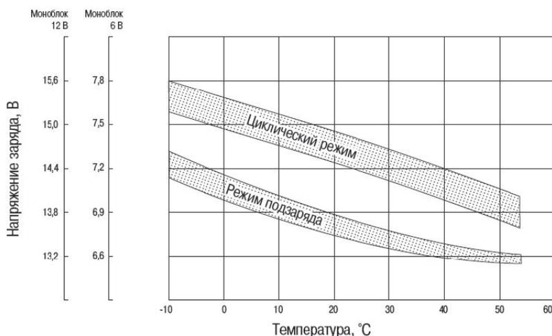
Рис. 4 Соотношение между напряжением заряда и температурой
